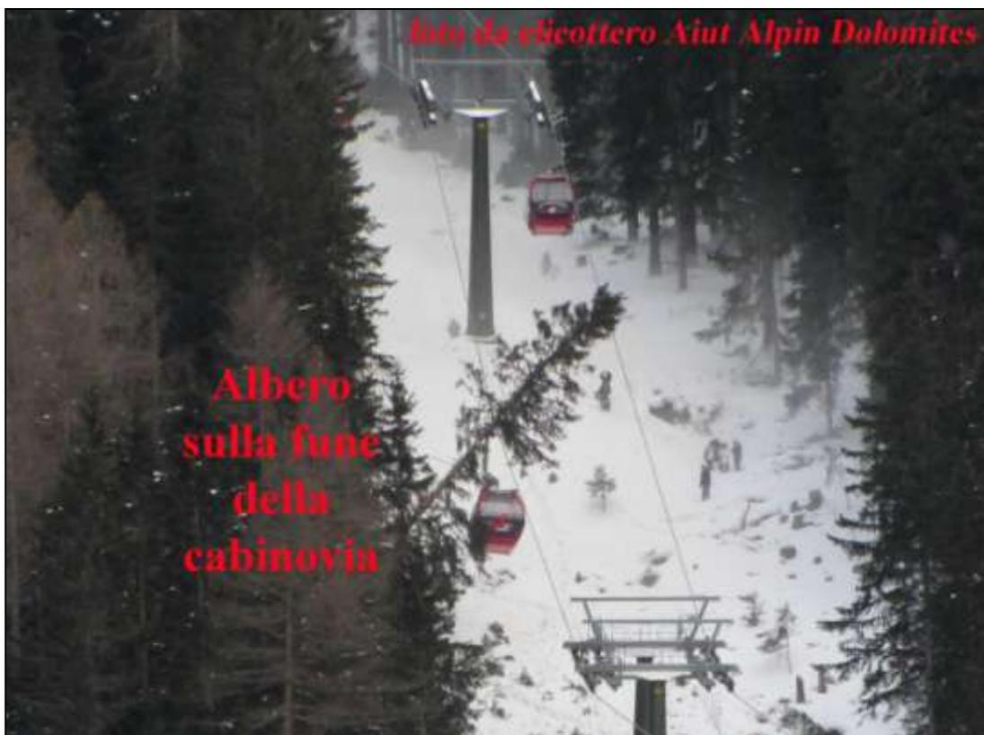
**CARATTERISTICHE TECNICHE DELL'IMPIANTO COINVOLTO.** Si tratta di una cabinovia monofune ad attacco temporaneo dei veicoli con capacità di trasporto di 2400 persone/ora; la quota della stazione a valle (Selva centro) è 1566 m s.l.m. mentre la quota a monte (Ciampinoi) è 2247 m s.l.m. con un dislivello totale di 681,5 m e con una pendenza media del 40%.
